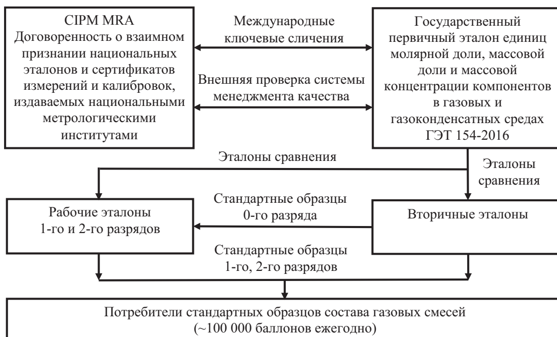
Рис. 1. Метрологическая прослеживаемость стандартных образцов состава газовых смесей в баллонах под давлением в соответствии с [1]
