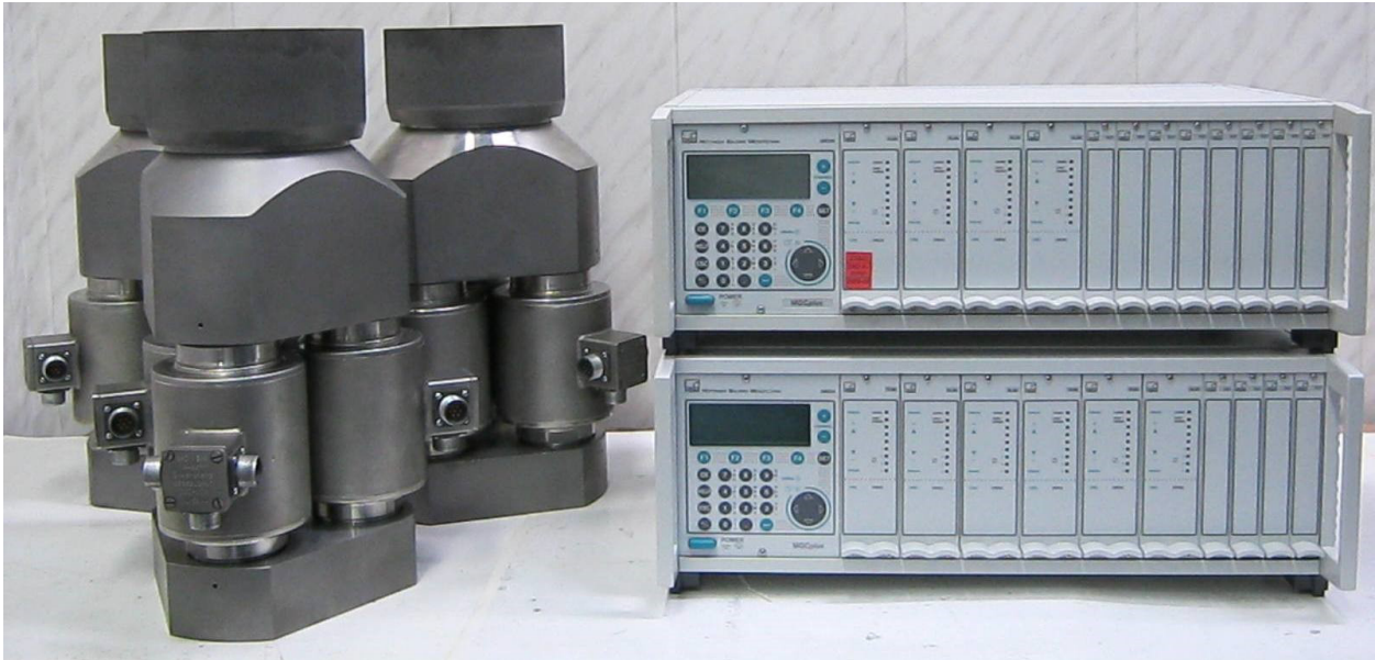
Рисунок подготовлен авторами по собственным данным / The figure is prepared by the authors using their own data Рис. 1. Внешний вид группы динамометров, применяемых во ФГУП «ВНИИМ им. Д. И. Менделеева» при передаче единицы силы
