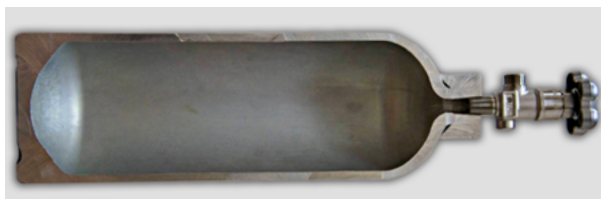
Рис. 2. Алюминиевый баллон, изготовленный методом холодной экструзии, в разрезе
