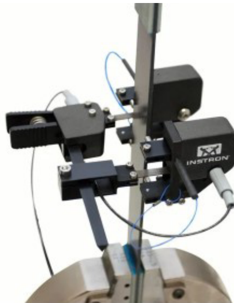
Рис. 2. Длинноходовой и навесной экстензометры Instron
