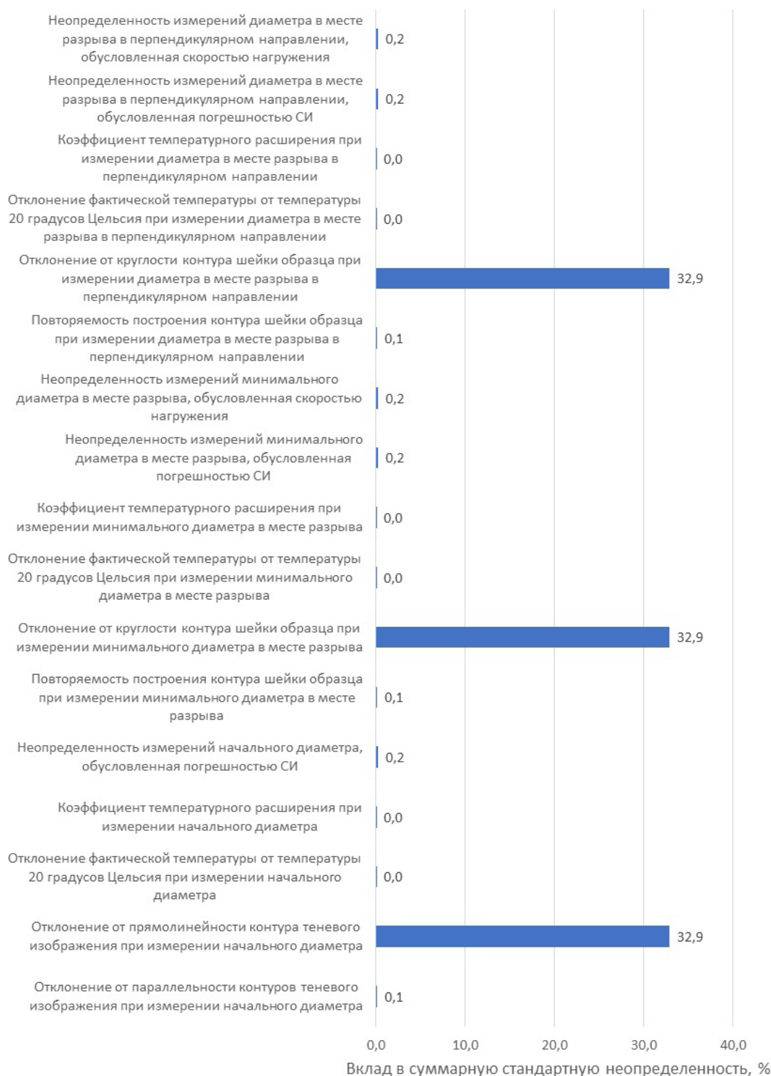
Рис. 9. Вклады от различных источников в суммарную стандартную неопределенность результатов измерений относительного сужения после разрыва
