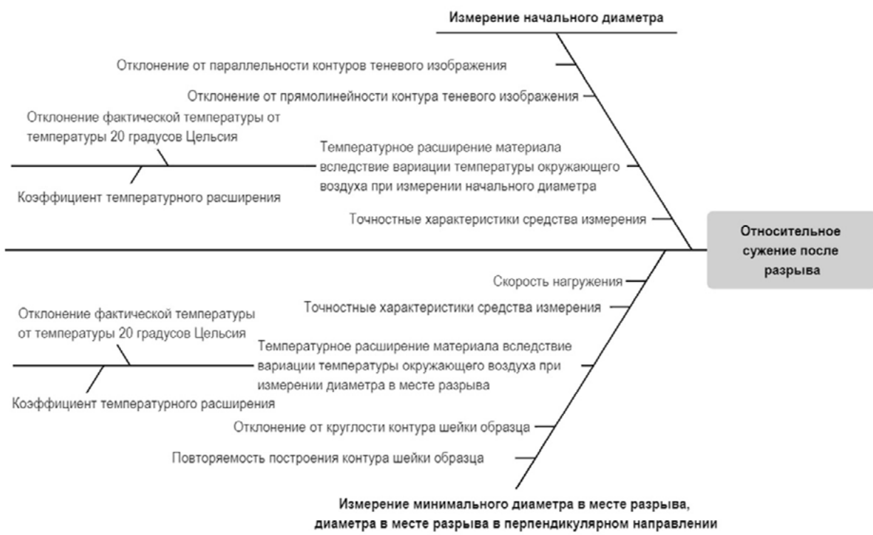
Рис. 7. Источники неопределенности при определении относительного сужения после разрыва Fig. 7. Sources of uncertainty in determining the relative contraction after rupture
