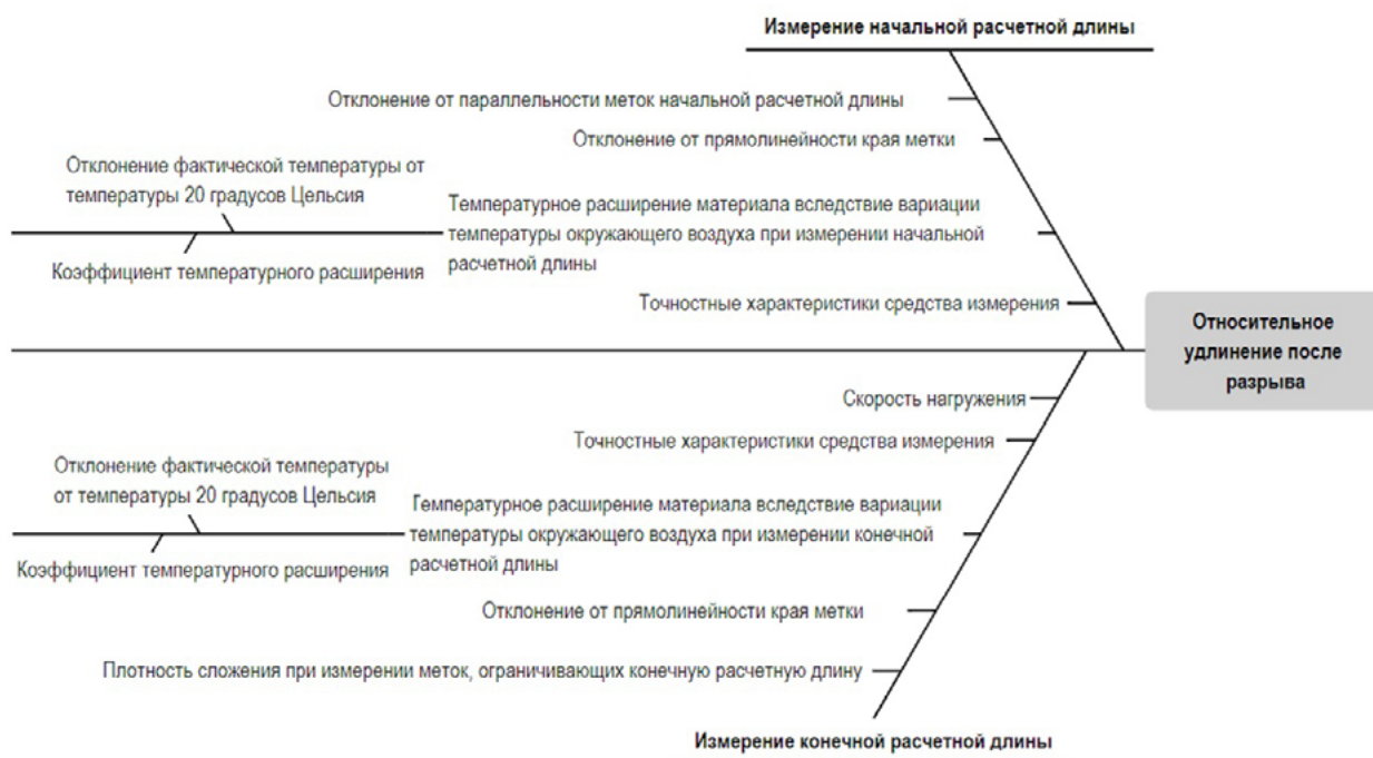
Рис. 6. Источники неопределенности при определении относительного удлинения после разрыва Fig. 6. Sources of uncertainty in determining relative elongation after rupture
