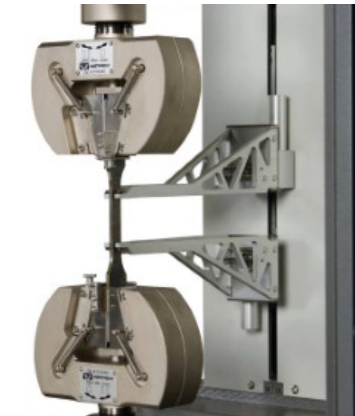
Рис. 2. Длинноходовой и навесной экстензометры Instron
