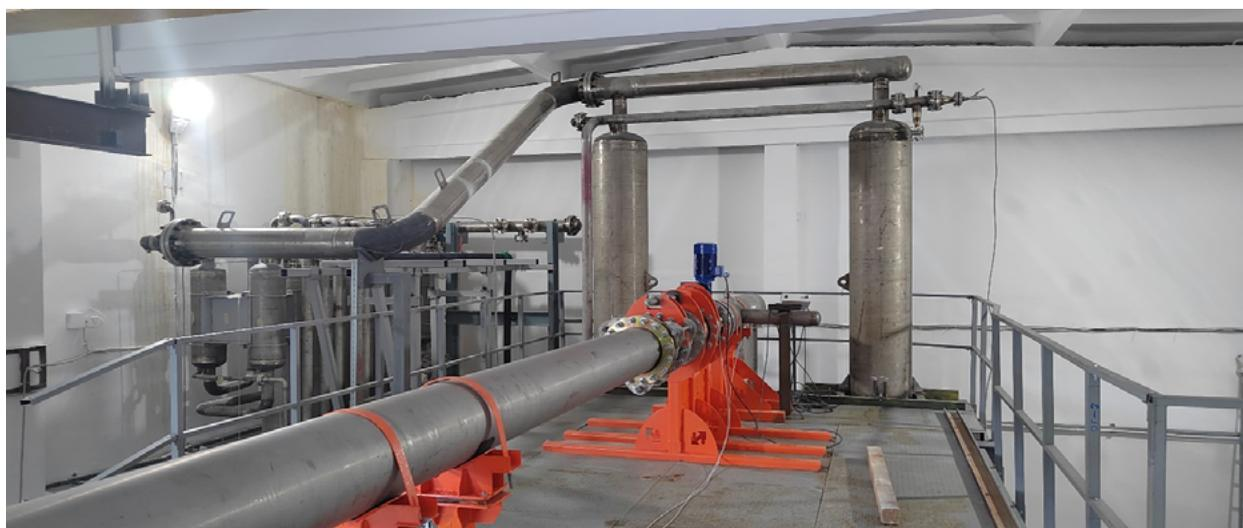
Рис. 2. Дожимная установка и газоотделитель в составе эталона
