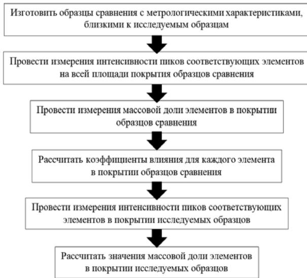
Рис. 3. Схема определения массовой доли элементов в покрытии
