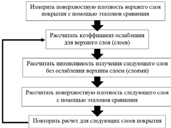
Рис. 1. Схема послойного определения поверхностной плотности покрытия
