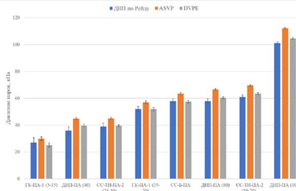
Рис. 4. Сравнение результатов определения давления паров материалов СО ДНП-ПА, СС-Б-ПА и ГК-ПА-1 ( $n = 3, P = 0,95$ )Fig. 4. Comparison of vapor pressure determination results for RM DNP-PA, SS-B-PA, and GK-PA-1 ( $n = 3, P = 0.95$ )
