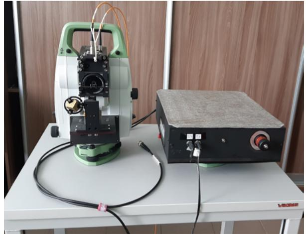
Рис. 2. Внешний вид макета высокоточного комплекса средств измерений приращений координат
