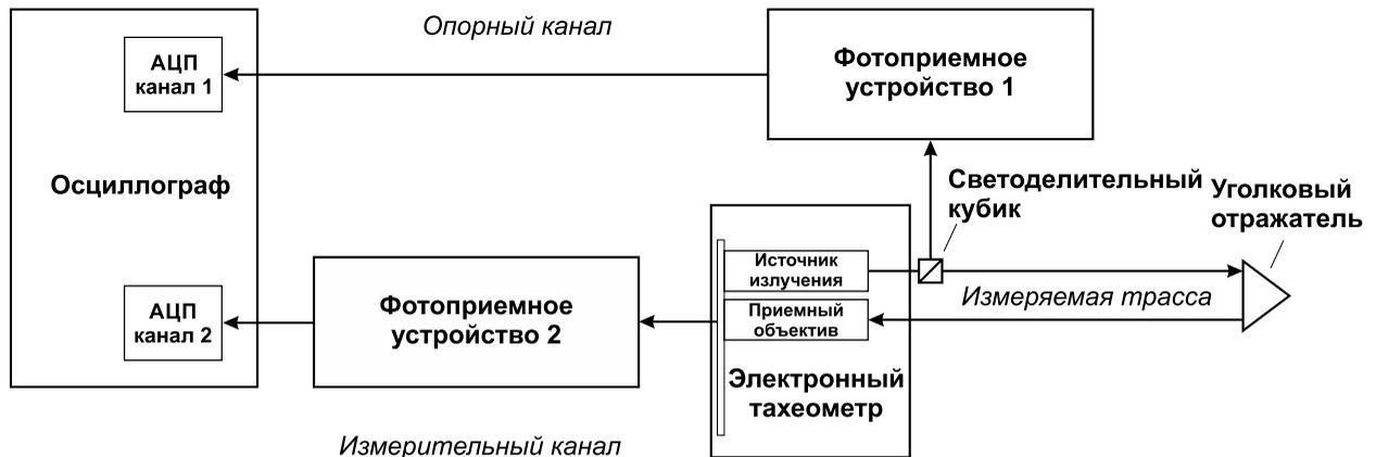
Рис. 1. Обобщенная схема макета высокоточного комплекса средств измерений приращений координат [14]
