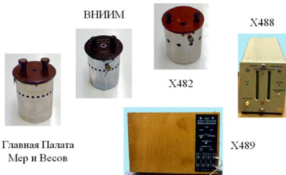
Рис. 4. Промышленно изготовленные нормальные элементы
