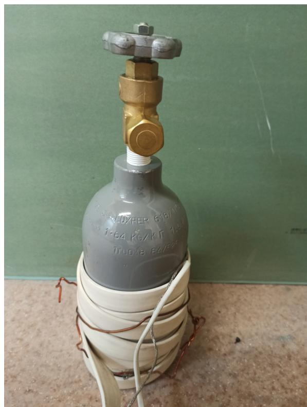
Рис. 1. Общий вид нагрева стандартного образца
