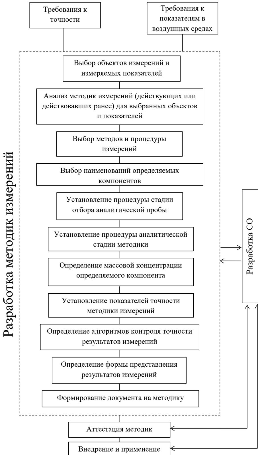
Рис. 1. Структурная схема разработки методик измерений состава воздушных сред
