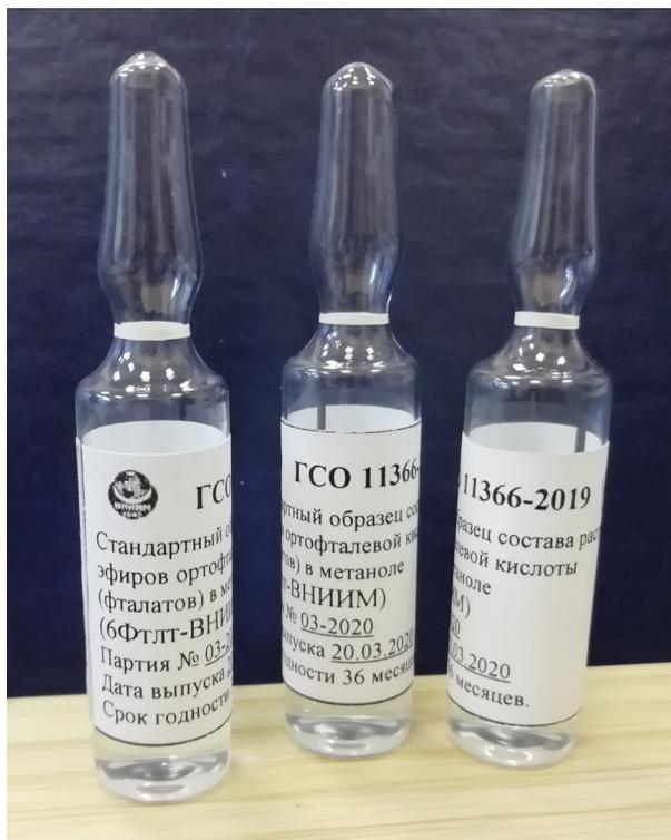
Рис. 3. Общий вид сертифицированного стандартного образца состава раствора эфиров ортофталевой кислоты (фталатов) в метаноле (6ФТЛТ-ВНИИМ) GSO 11366–2019.
