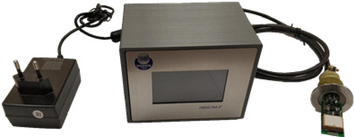
Рис. 5. Опытный образец деформационно-частотного вакуумметра [8]
