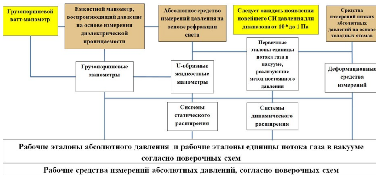
Рис. 8. Структурно-иерархическая схема комплекса первичных эталонов давления передовых стран, опирающаяся на первичные эталоны, методы измерений которых основаны на фундаментальных константах
