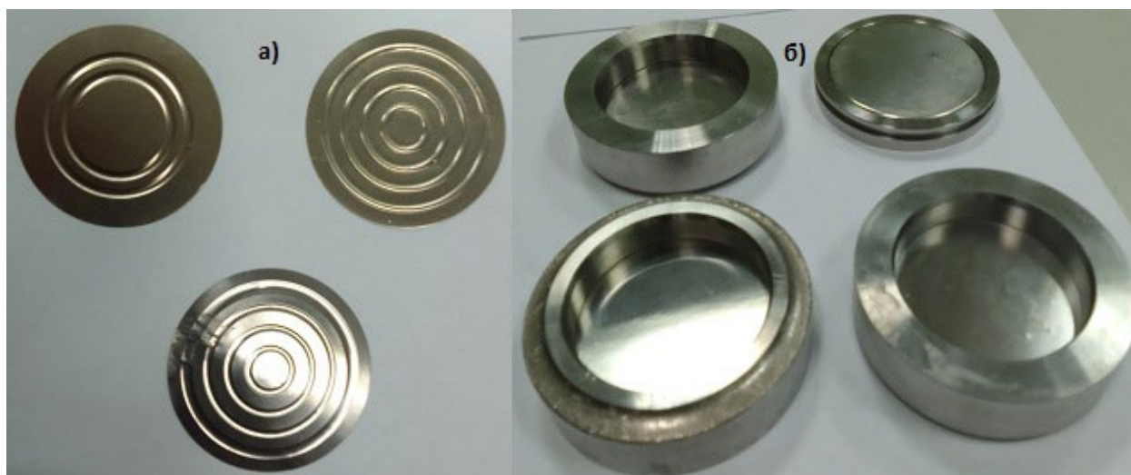
Рис. 1. а) Макеты мембран, изготовленные для мембранно-емкостного преобразователя; б) мембранные узлы с различными видами заделки мембран (пайка, сварка, защемление)
