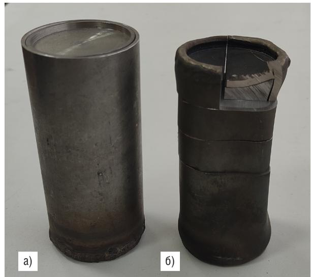
Рис. 2. Внешний вид капсул материала стандартных образцов для спектрального анализа сплава алюминиевого ВСДП-16: а) до высокотемпературной газостатической обработки; б) после высокотемпературной газостатической обработки
