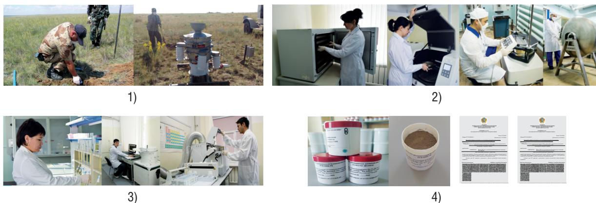
Рис. 2. Основные этапы производства СО удельной активности техногенных радионуклидов и массовой доли элементов на основе почвенной матрицы СИП, разработанной филиалом «Институт радиационной безопасности и экологии» Национального ядерного центра Республики Казахстан, где: 1 – отбор исходного материала с территории СИП; 2 – лабораторная пробоподготовка СО; 3 – лабораторные анализы СО; 4 – внешний вид СО
