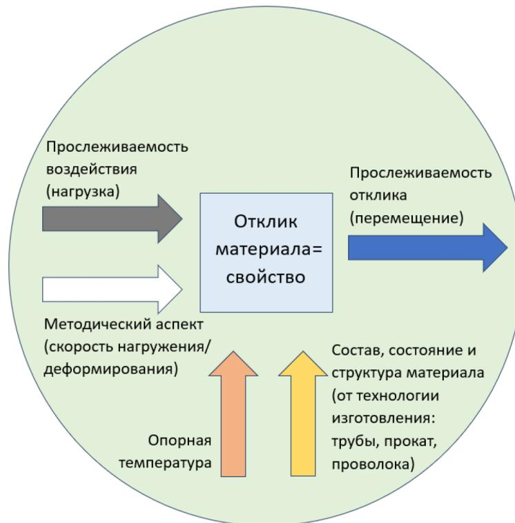
Рис. 1. Доверительная область измерений при испытании для определения свойств материала [3]
