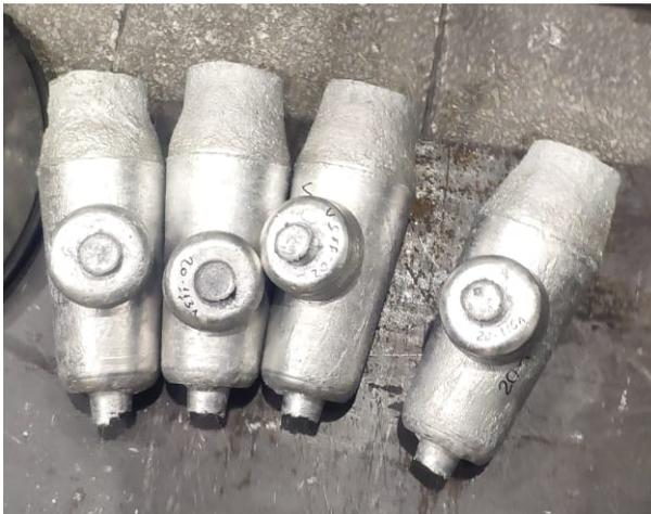
Рис. 1. Внешний вид отливок материала стандартных образцов для спектрального анализа сплава алюминиевого ВСДП-16
