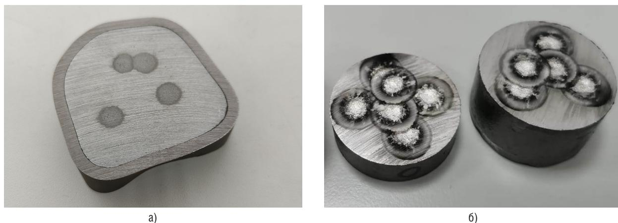
Рис. 4. Вид прожогов материалов стандартного образца для спектрального анализа сплава алюминиевого ВСДП-16: а) после ВГО; б) после горячего прессования
