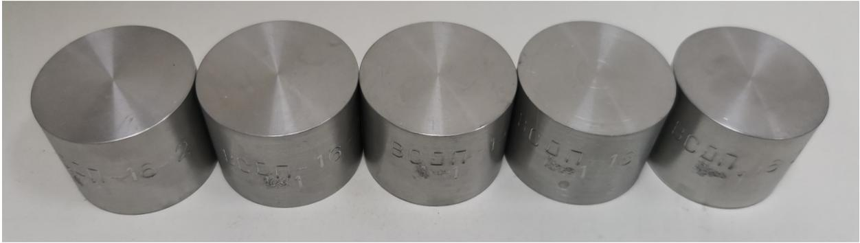
Рис. 5. Комплект стандартных образцов для спектрального анализа сплава алюминиевого ВСДП-16
