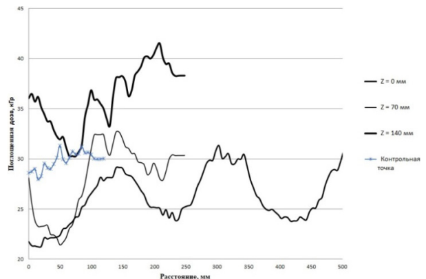
Рис. 9. Распределение поглощенной дозы в блоке продукции «Перчатки медицинские диагностические одноразовые стерильные»
