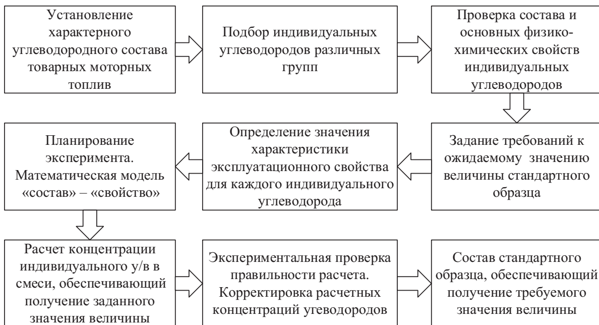
Рис. 1. Метод обоснования состава стандартных образцов эксплуатационных свойств моторных топлив
