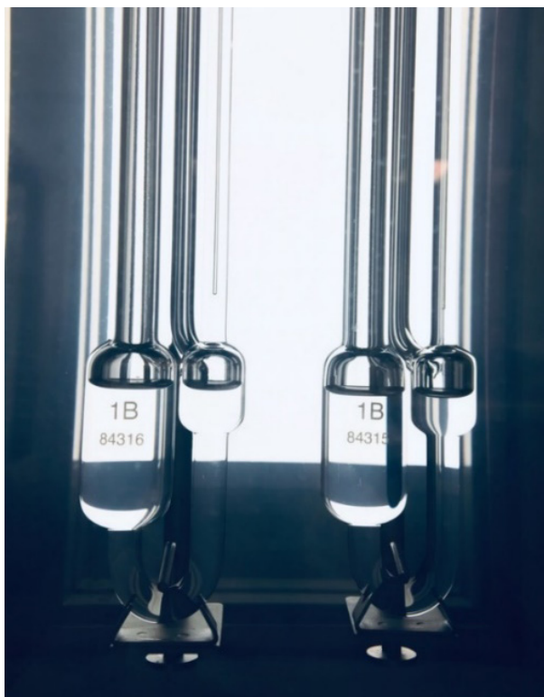
Рис. 7. Полиальфаолефиновое масло, помещенное в капиллярном стеклянном вискозиметре в термостатическую ванну при температуре – 30 °С
