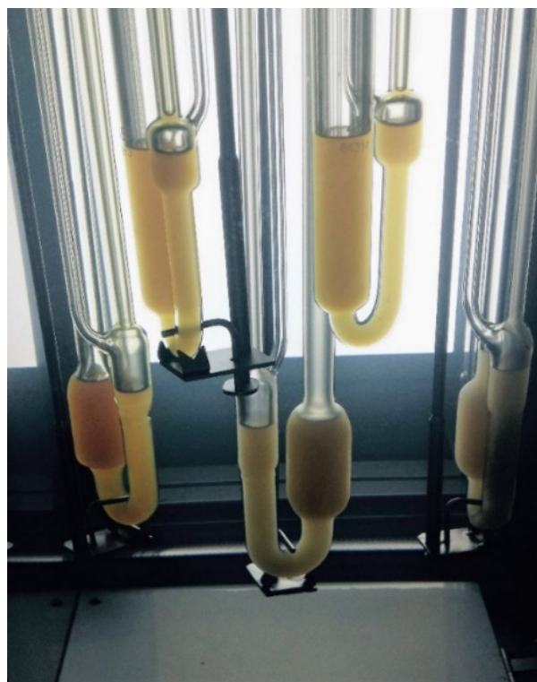
Рис. 6. Моторные масла, помещенные в капиллярном стеклянном вискозиметре в термостатическую ванну при температуре -30 ^\circ\text{C}
