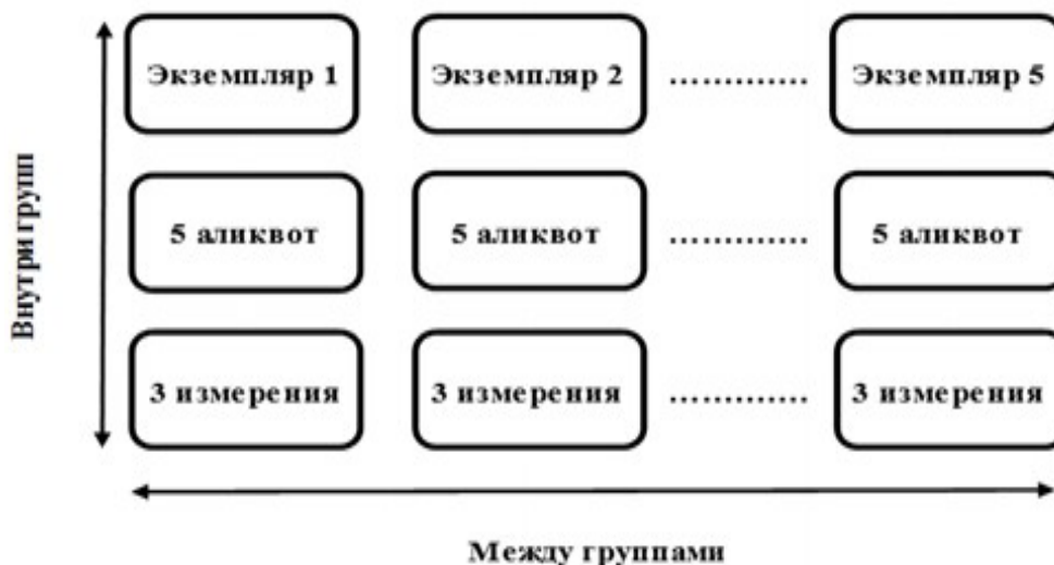
Рис. 3. Алгоритм исследования однородности стандартного образца состава раствора эфиров ортофталевой кислоты (фталатов) в метаноле
