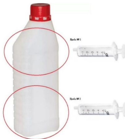
Рис. 1. Схема отбора представительной пробы моторного масла Mobil 1 10W-60
