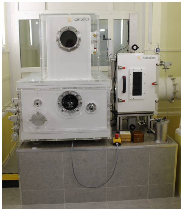
Рис. 5. Вакуумный компаратор CCL 1007 (Sartorius, Германия) с вакуумной транспортной системой VTS Fig. 5. CCL 1007 vacuum comparator (Sartorius, Germany) with VTS – vacuum transfer system
