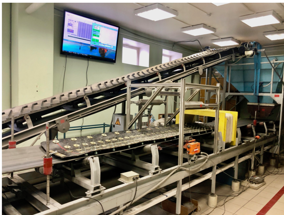
Рис. 2. Установка измерения массы на конвейерных весах
