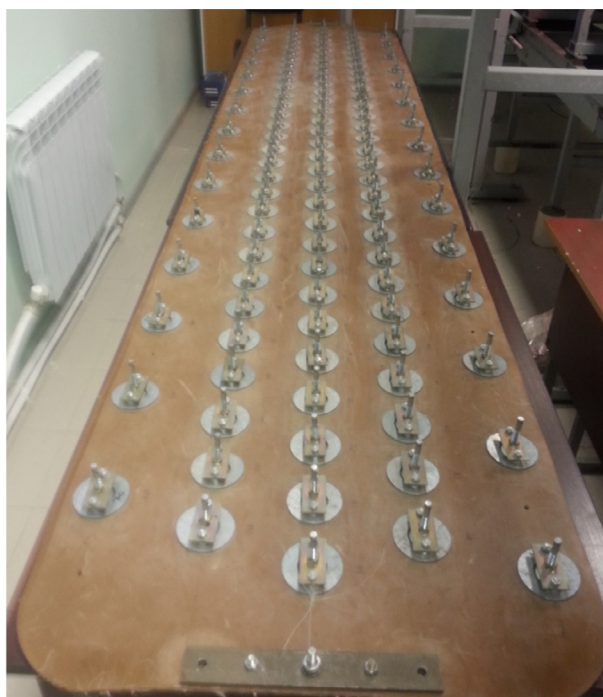
Рис. 6. Внешний вид меры линейной плотности МЛП-10
