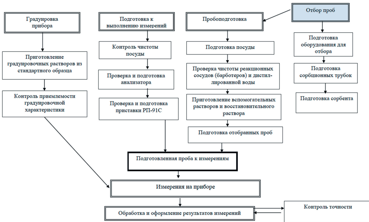
Рис. 1. Схема методики измерений массовой концентрации ртути в газовых смесях методом ААС «холодного пара»
