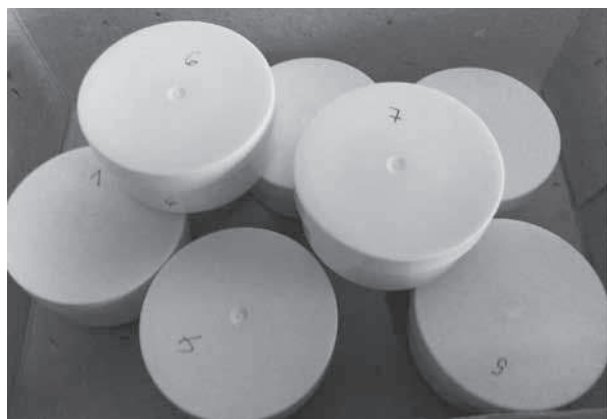
Рис. 3. Стандартный образец смолы IONEX, упакованный в семь одинаковых контейнеров
