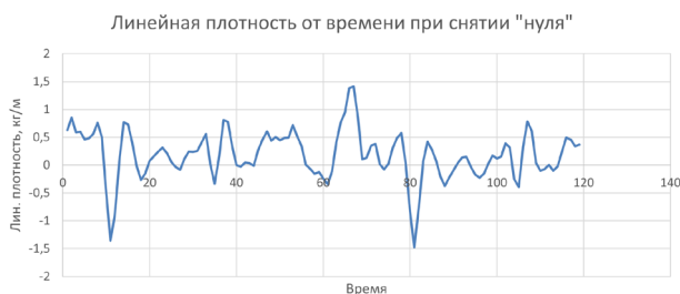
Рис. 5. График определения нулевых показаний датчиков АЦП
