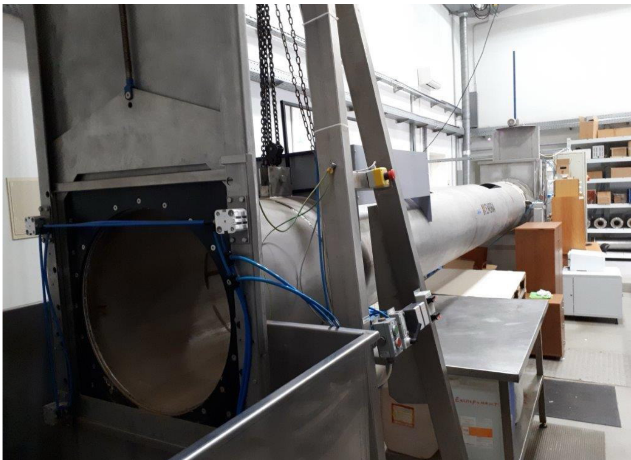
Рис. 1. Внешний вид установки поверочной УПР СВ 600
