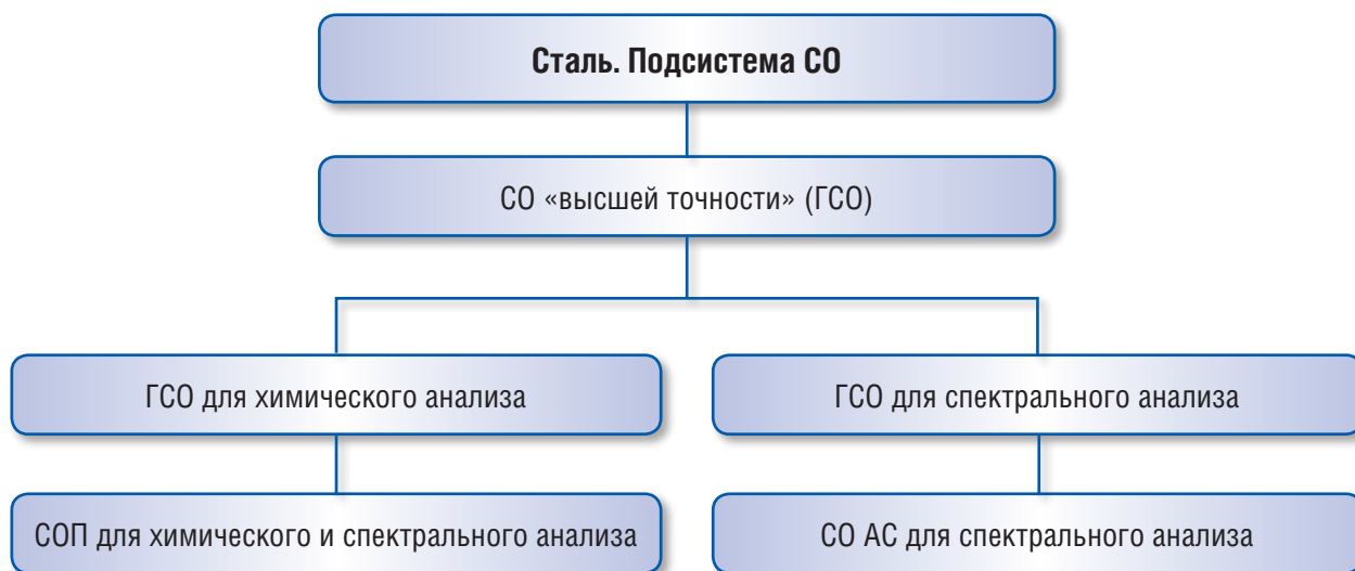
Рис. 4. Структура подсистемы СО стали
