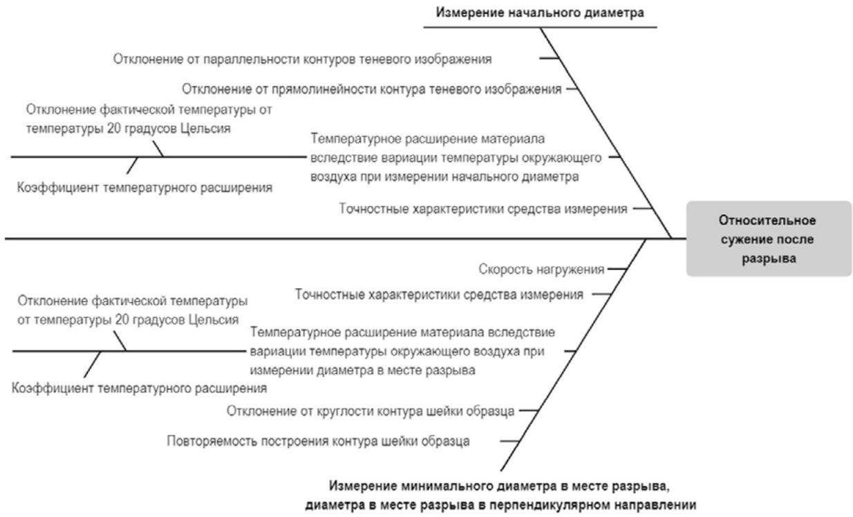
Рис. 7. Источники неопределенности при определении относительного сужения после разрыва
