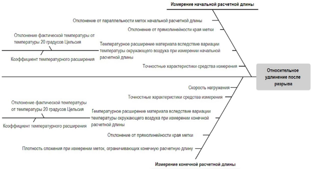
Рис. 6. Источники неопределенности при определении относительного удлинения после разрыва
