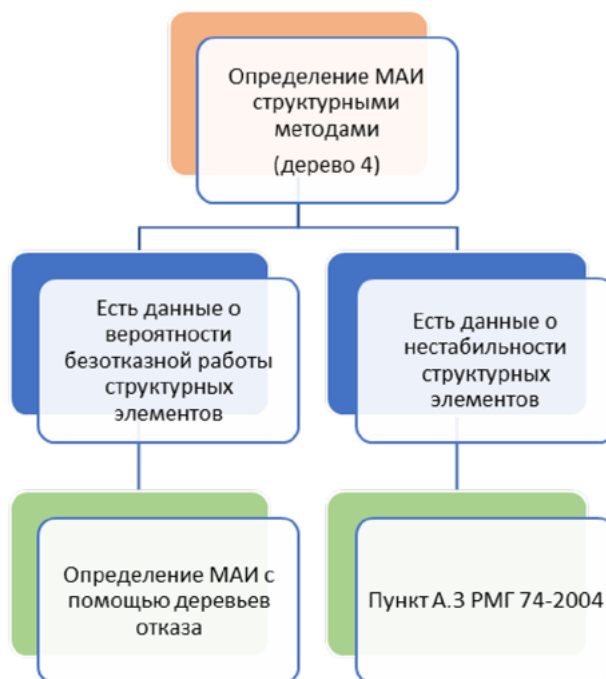
Рис. 4. Дерево выбора метода определения МАИ структурными методами
