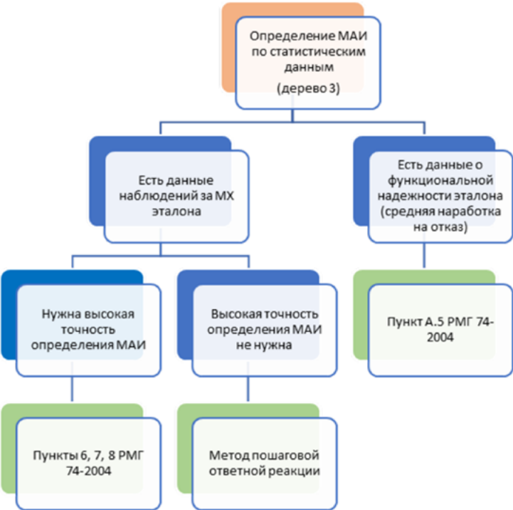
Рис. 3. Дерево выбора метода определения МАИ по статистическим данным Fig. 3. The selection tree of the method for determining the interval between attestations based on statistical data
