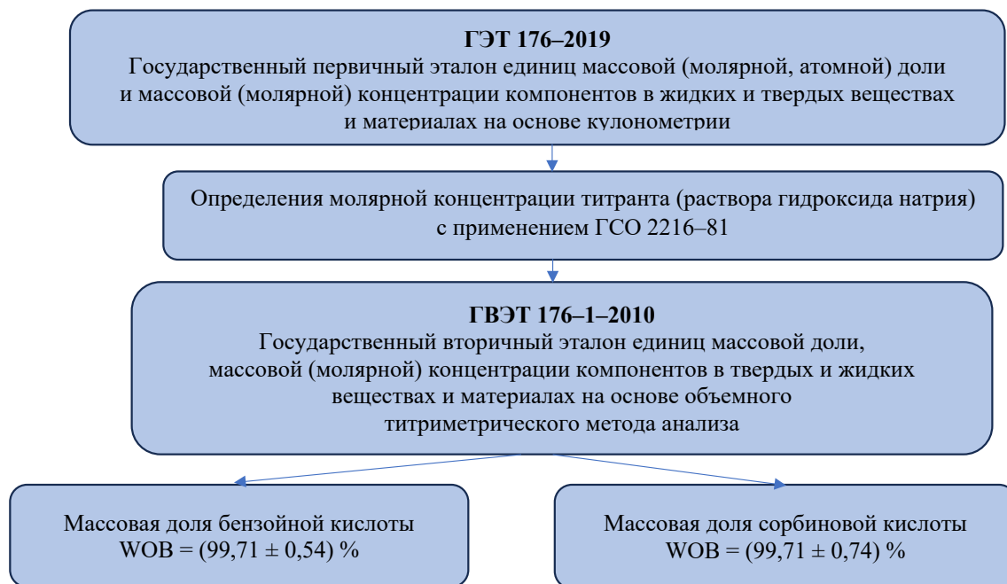
Рис. 9. Схема получения результатов измерений титриметрическим методом
