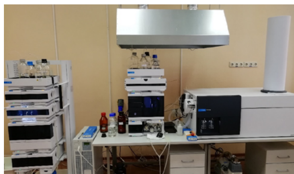
Рис. 1. Внешний вид и состав установки: хроматограф жидкостный Agilent 1260 Infinity II LC с детектором 1260 DAD WR, хроматограф жидкостный Agilent 1290 Infinity II LC с тандемным квадрупольно-времяпролетным масс-спектрометрическим детектором Agilent Q-TOFLC/MS6530
