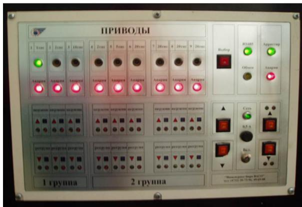
Рис. 7. Пульт управления эталонной установки ЭУ-100 (фотография выполнена автором)
