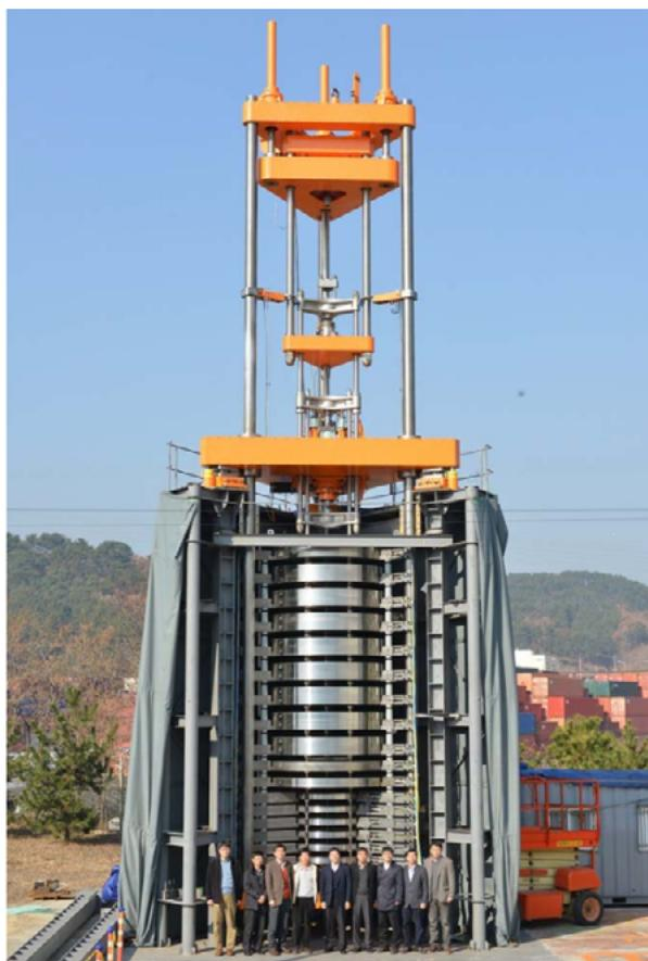
Рис. 4. Фото эталонной силовоспроизводящей установки прямого нагружения KRISS (Республика Корея) [4]
