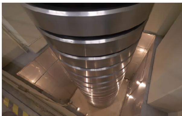
Рис. 1. Фрагмент эталонной силовоспроизводящей установки прямого нагружения в диапазоне от 222 до 4 448 кН института NIST [1]
