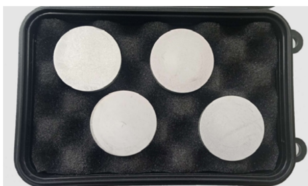
Рис. 5. Внешний вид набора ГСО 11156–2018/ГСО 11159–2018 стандартных образцов состава, поверхностной плотности, толщины олово-висмутового покрытия на меди
