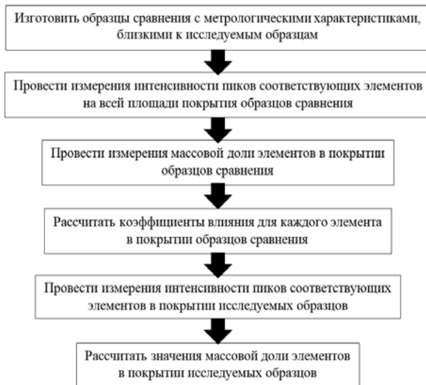
Рис. 3. Схема определения массовой доли элементов в покрытии
