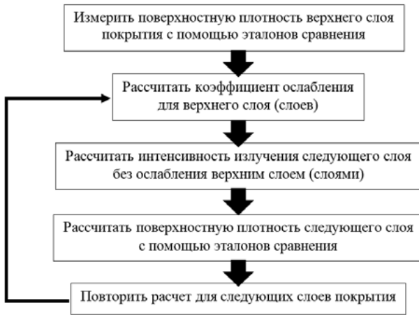
Рис. 1. Схема послойного определения поверхностной плотности покрытия
