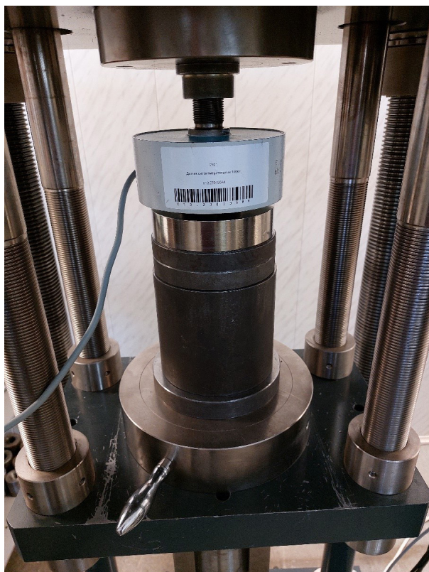
Рис. 4. Проведение измерений на аттестуемом эталоне единицы силы 1 разряда
