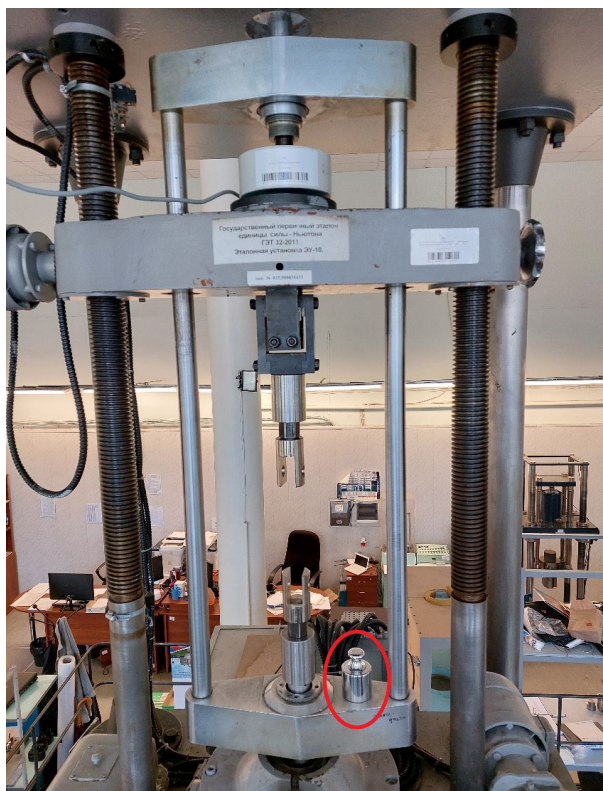
Рис. 3. Оценка чувствительности динамометра-компаратора при помощи гири на эталоне силы прямого нагружения ГЭТ 32–2011
