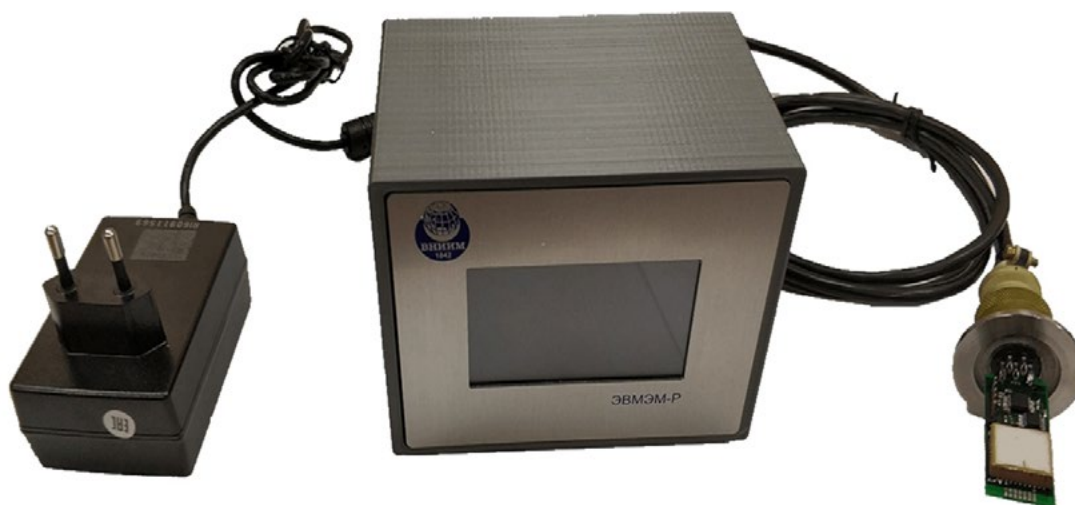
Рис. 3. Опытный образец высокоточного деформационно-частотного вакуумметра
