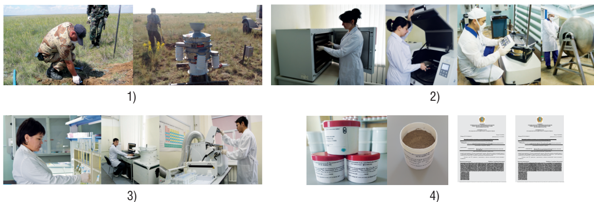
Рис. 2. Основные этапы производства СО удельной активности техногенных радионуклидов и массовой доли элементов на основе почвенной матрицы СИП, разработанного филиалом «Институт радиационной безопасности и экологии» Национального ядерного центра Республики Казахстан, где: 1 – отбор исходного материала с территории СИП; 2 – лабораторная пробоподготовка СО; 3 – лабораторные анализы СО; 4 – внешний вид СО
