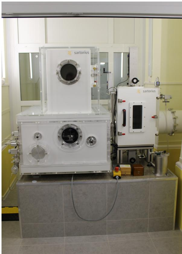
Рис. 1. Вакуумный компаратор CCL 1007 (Sartorius, Германия) с вакуумной транспортной системой VTS
